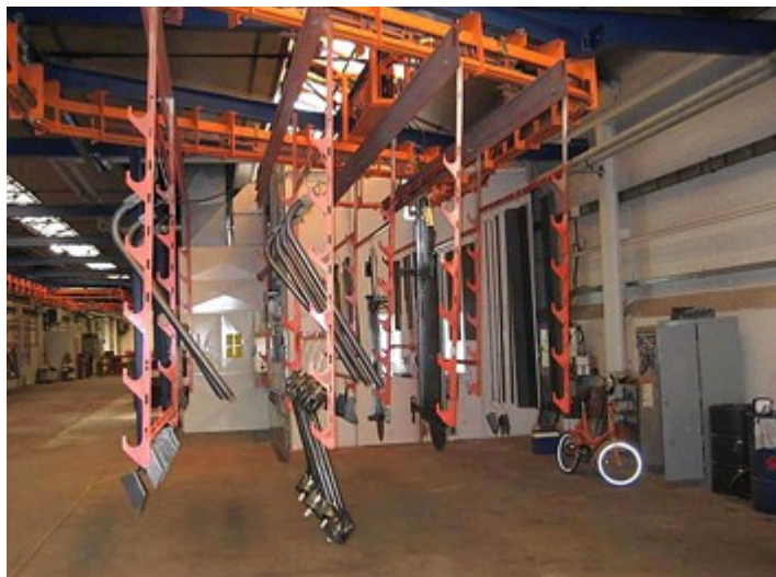
Les pièces jusqu'à 700 kg sont suspendues à un système de rails pour être pulvérisées dans la cabine verticale
