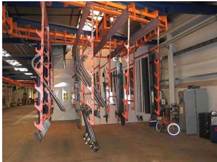
Stukken tot 700 kg worden aan een railsysteem opgehangen om in de verticale cabine te worden gespoten
